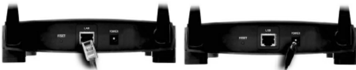
Gambar 10 Cara menghubungkan kabel ethernet dan kabel power pada WAP54G
