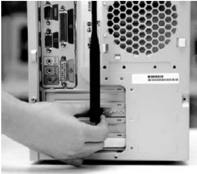
Gambar 21 Contoh pemasangan antenna pada WNA PCI
