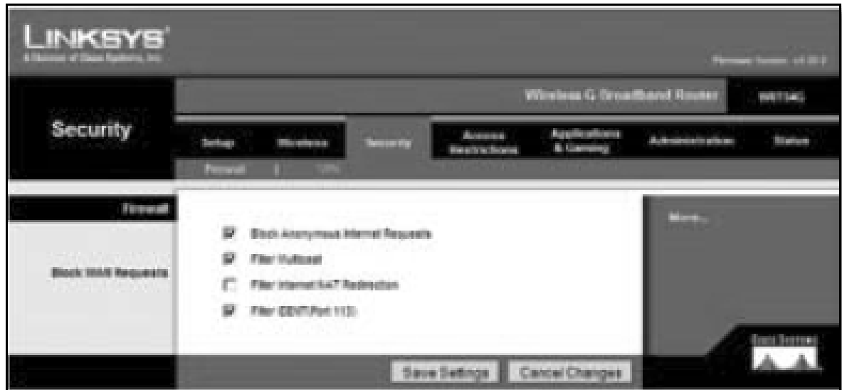
Gambar 19 Contoh tampilan konfigurasi firewall
