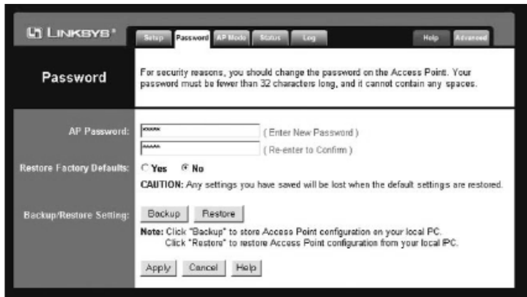
Gambar 11 Contoh tampilan untuk merubah password AP
