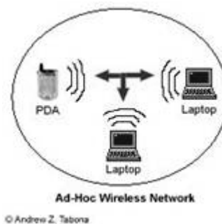
Gambar 1 Skema konfigurasi Adhoc
