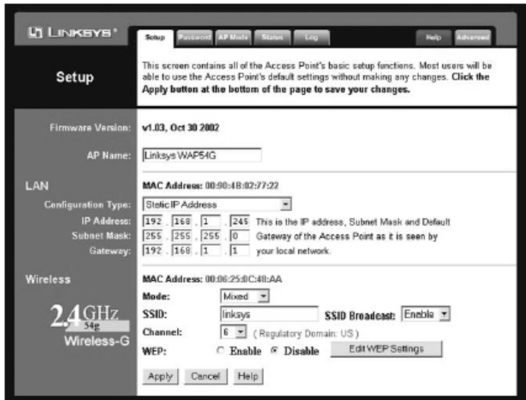
Gambar 12 Contoh tampilan konfigurasi LAN dan WLAN
