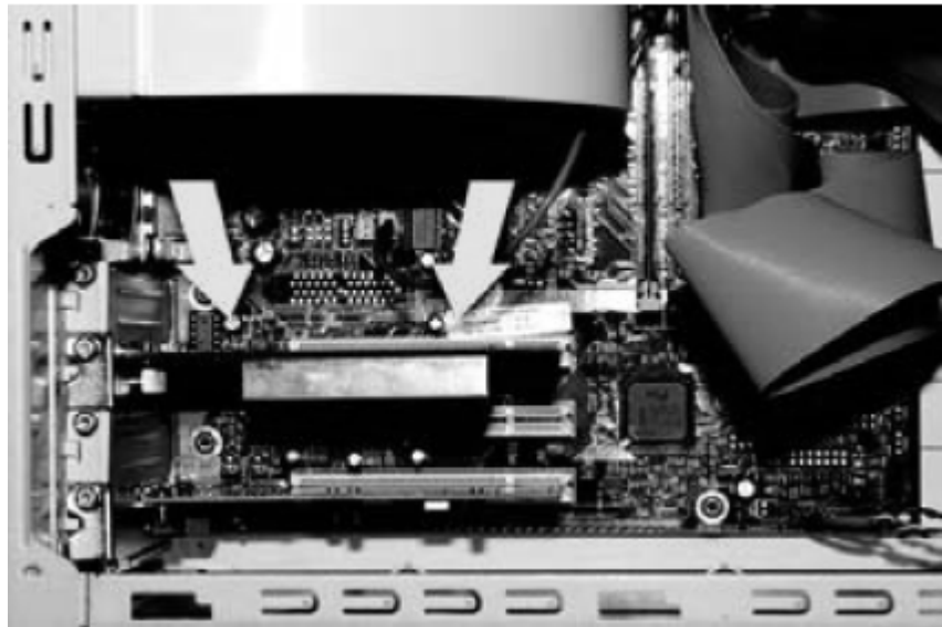
Gambar 20 Contoh pemasangan WNA PCI ke PCI slot
